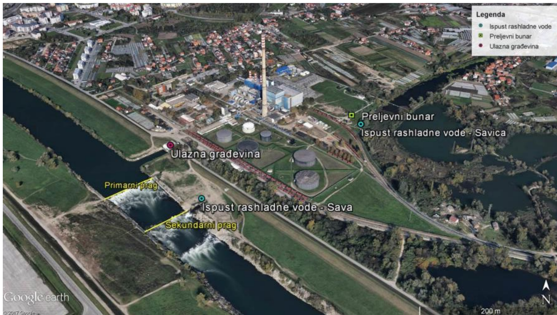
Slika 1-5 Glavni elementi rashladnog sustava TE-TO Zagreb
