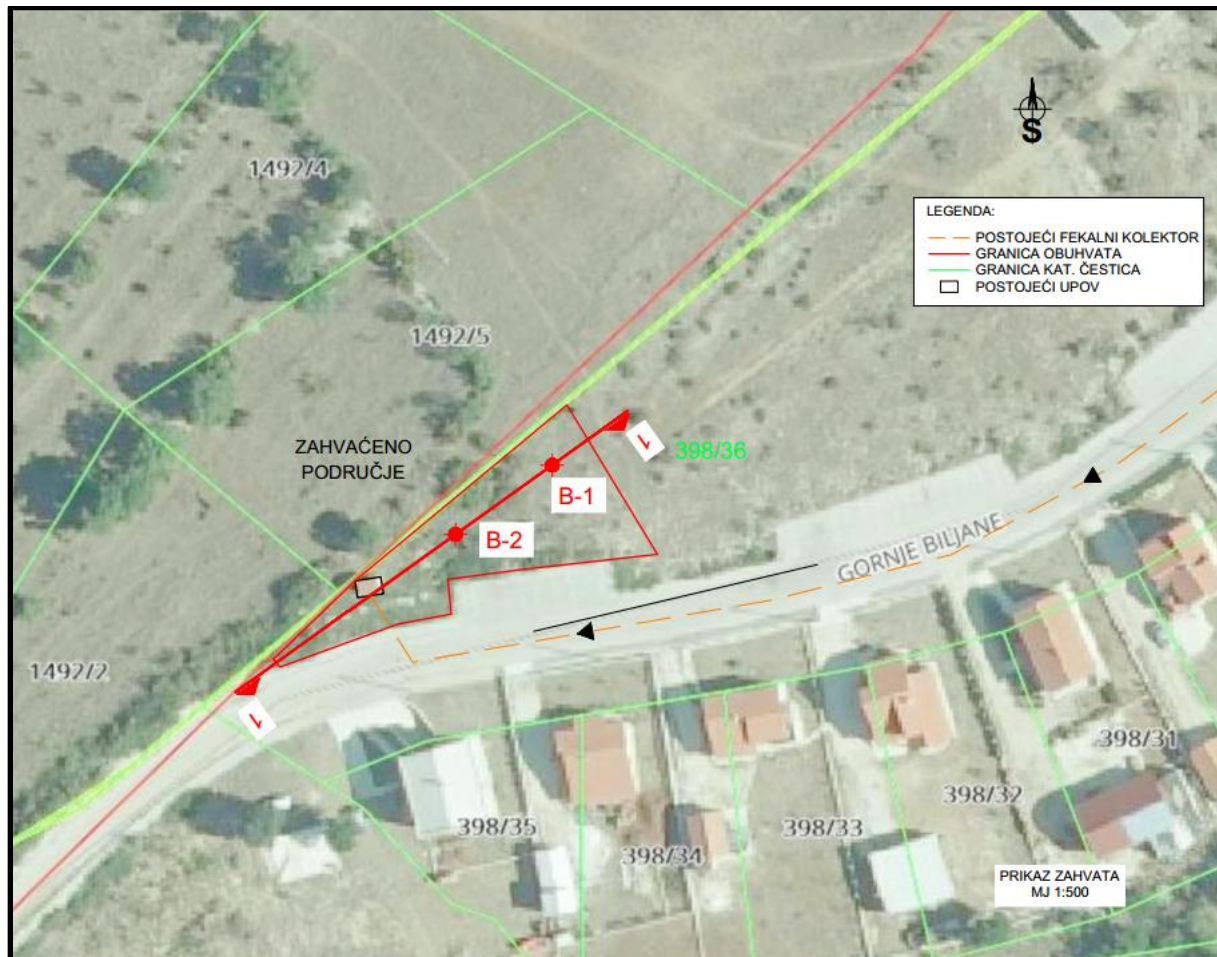
Slika 3.1.3-2. Geotehnički istražni radovi - situacija s položajem istražnih bušotina (Izvor: Institut IGH d.d., 2018)
