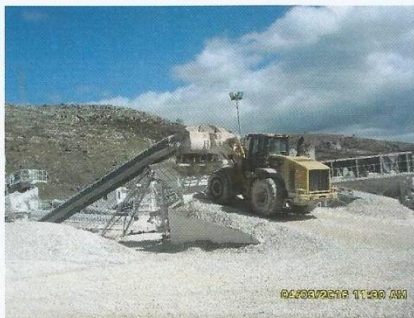
Slike 2. Tehnološki postupci u kameneolomu (transport materijala, utovar u kamione i transport kamionima, drobljenje kamena, utovar u dozator postrojenja..)
