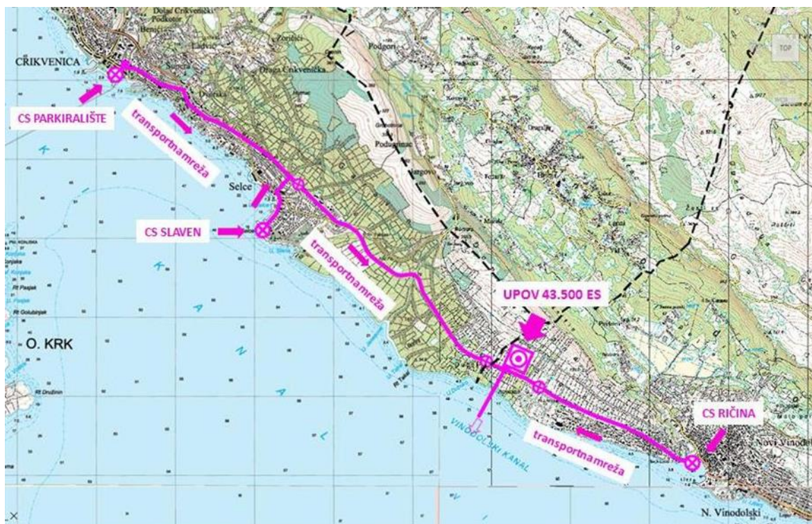
Slika 2.2.1-3. Prikaz koncepta sustava odvodnje sa zajedničkim uređajem za pročišćavanje otpadnih voda na rubnom području Novog Vinodolskog (Varijanta B)
