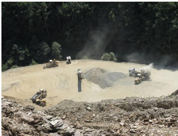
Slika 1.8. Utovar utovaračima tehničko-građevnog kamena u dampere
