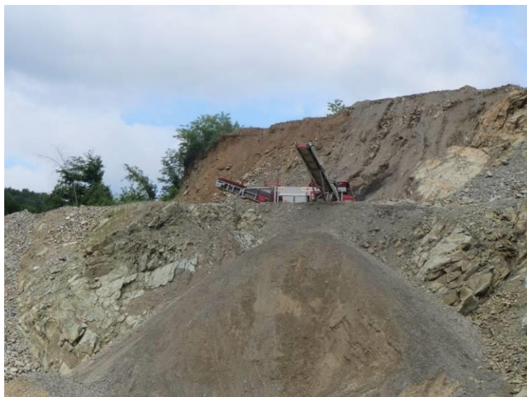
Slika 1.11. Pokretno postrojenje za sitnjenje i klasiranje – rad na etaži
