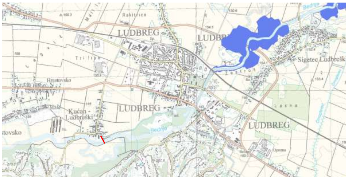
Slika 4-22 Obuhvat plavljenja za vodni val 10-godišnjeg PP (h.s. Ludbreg: Q_{PP10} = 123.3 \text{ m}^3/\text{s} )
