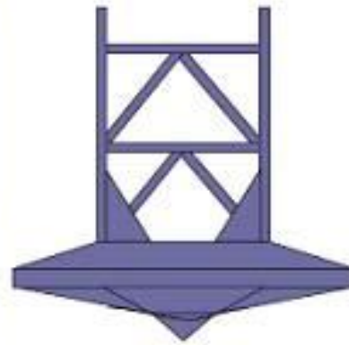
Slika 8. Potporne papuče sa konusnim dnom koju moraju da imaju svi stubovi kod samopodižuće platforme sa nezavisnim nogama.
