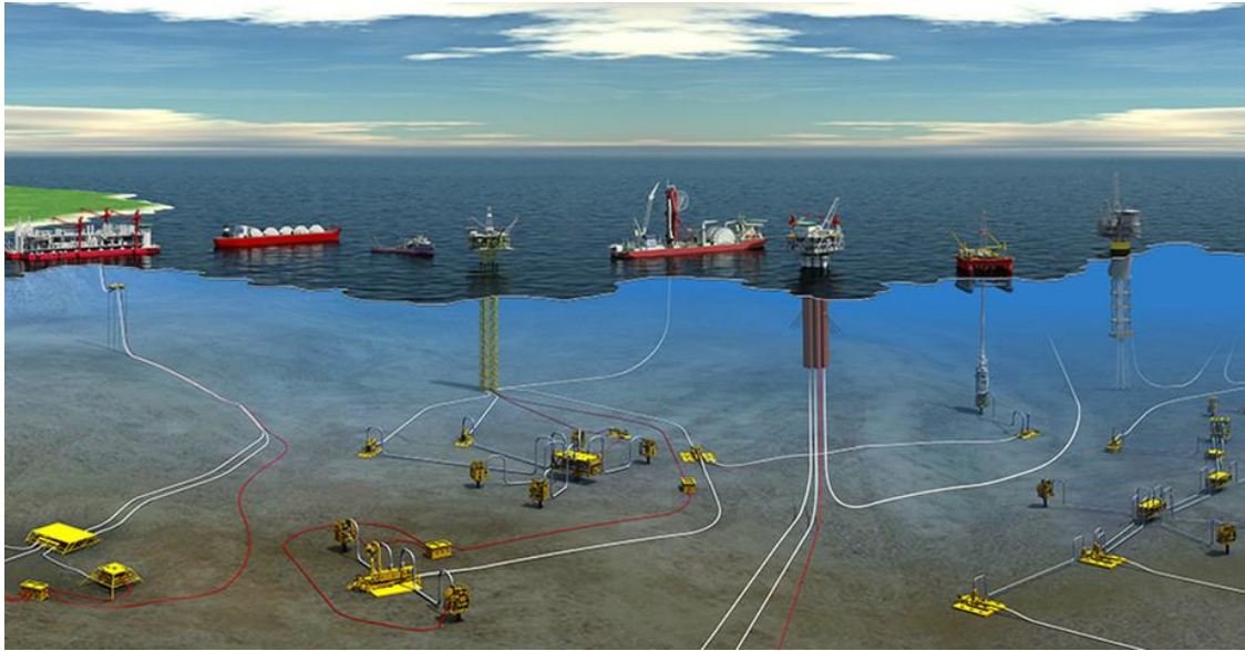
Slika 16. Tipičan razvoj podvodnog proizvodnog sistema, povezanog sa postrojenjima
