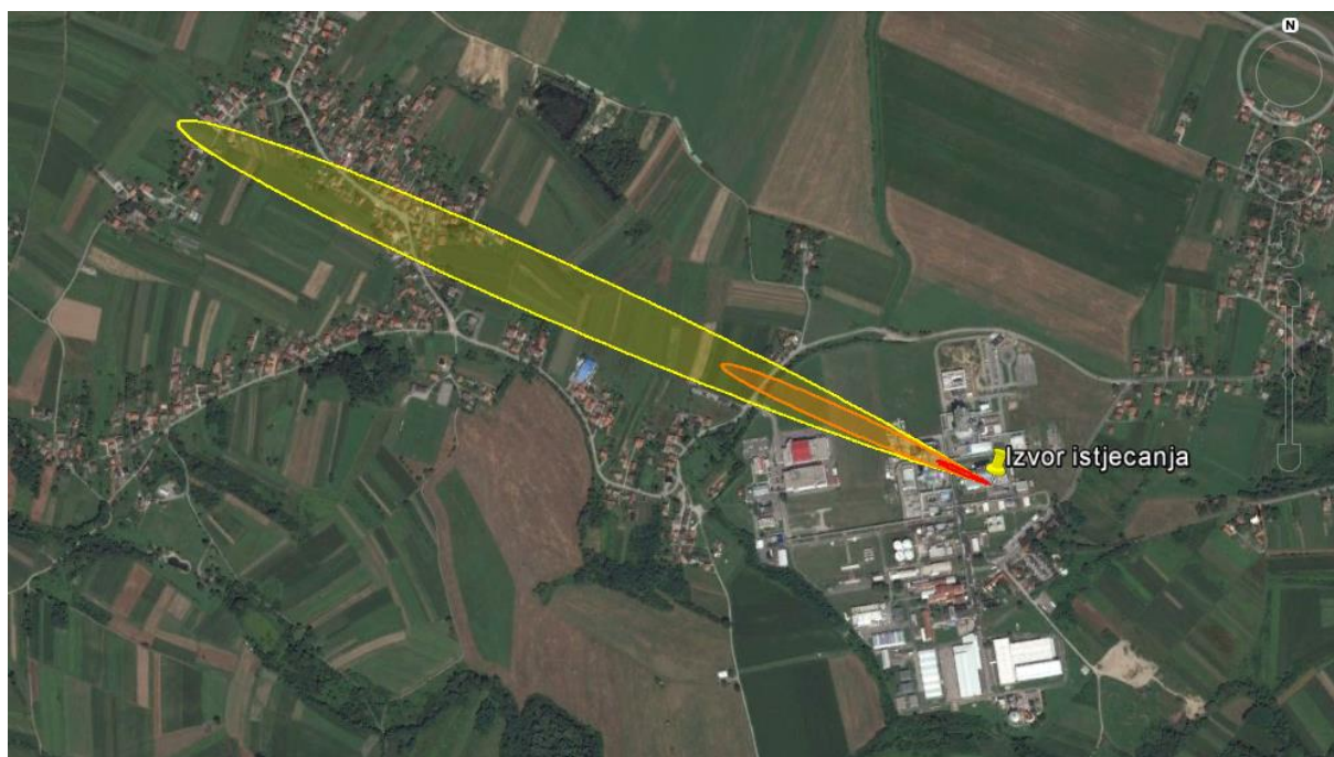
Slika 41. - Prikaz zona ugroženosti u slučaju ispuštanja amonijaka
