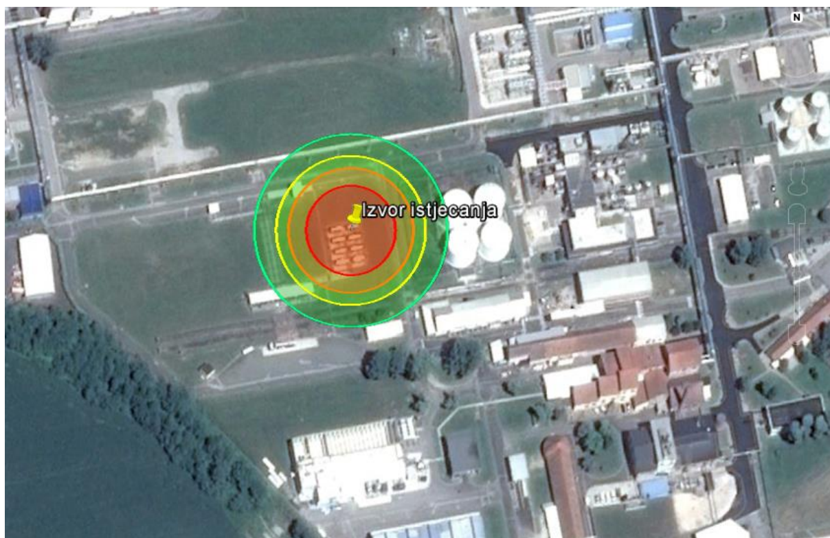
Slika 53. - Zone ugroženosti uslijed zapaljenja para acetona, metanola, etanola, izopropanola i toluena
