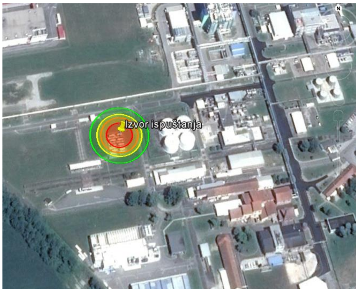
Slika 51. - Zone ugroženosti uslijed zapaljenja acetona – kolaps spremnika
