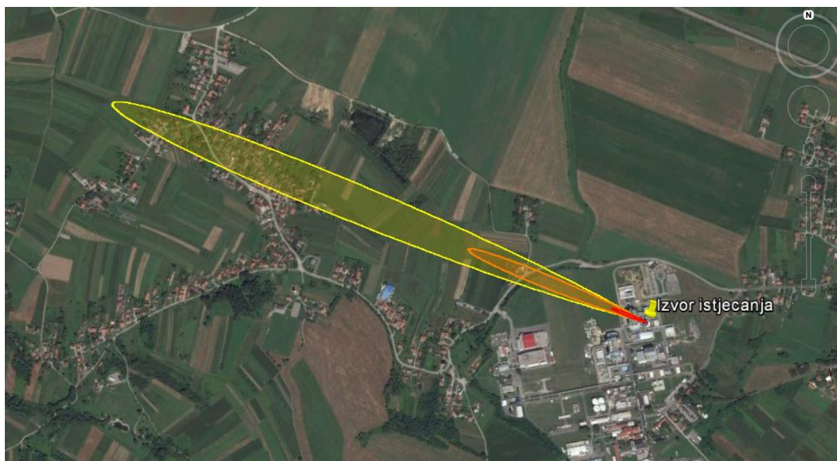
Slika 47. - Prikaz zona ugroženosti u slučaju ispuštanja amonijaka
