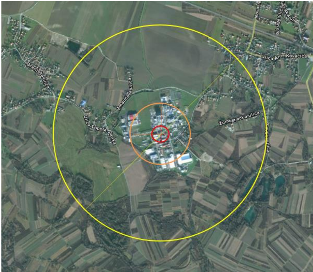
Slika 13. - Zone ugroženosti uslijed istjecanja cjelokupne količine medija iz horizontalnog spremnika amonijevog hidroksida (25%)
