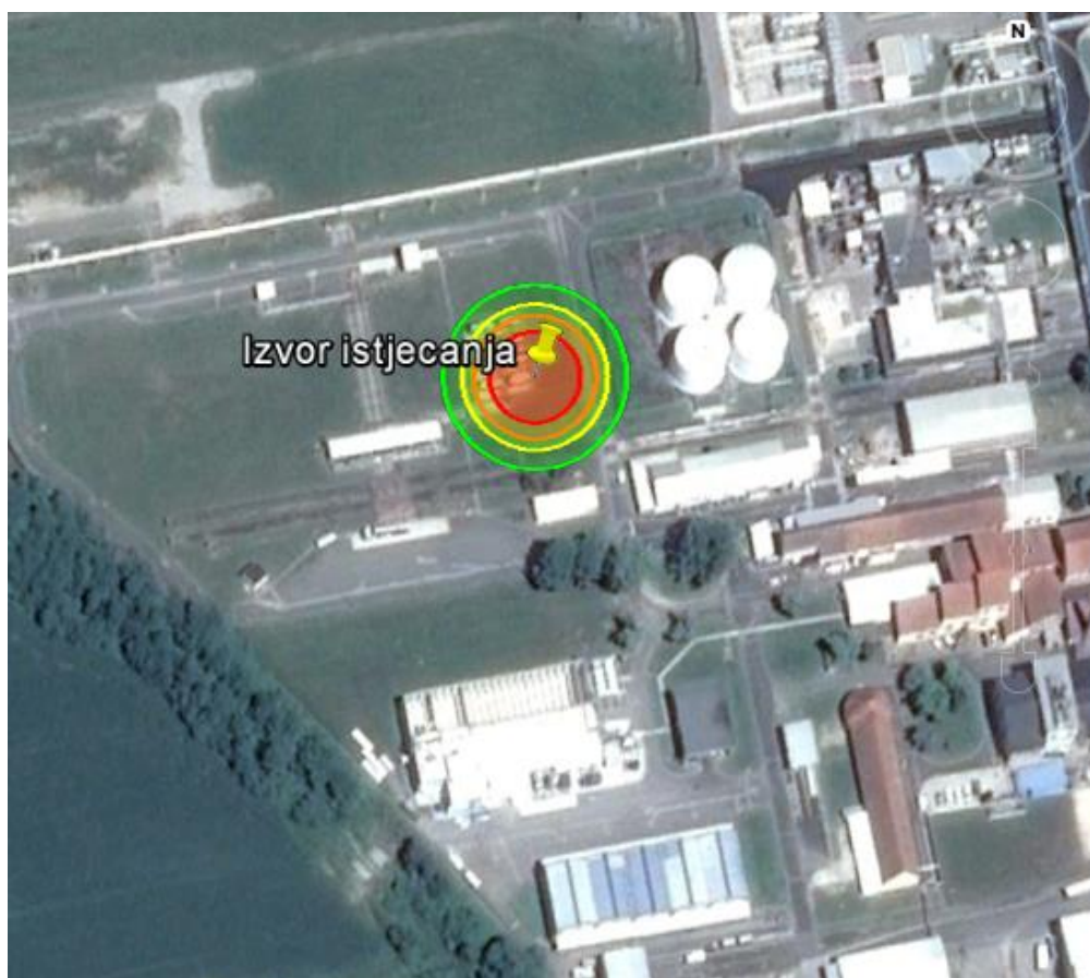
Slika 52. - Zone ugroženosti uslijed zapaljenja metanola – kolaps spremnika
