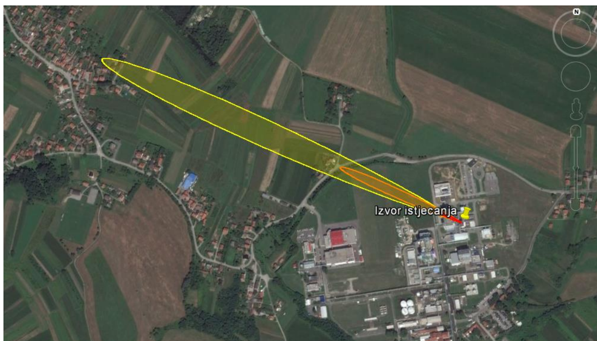
Slika 50. - Prikaz zona ugroženosti u slučaju ispuštanja amonijaka
