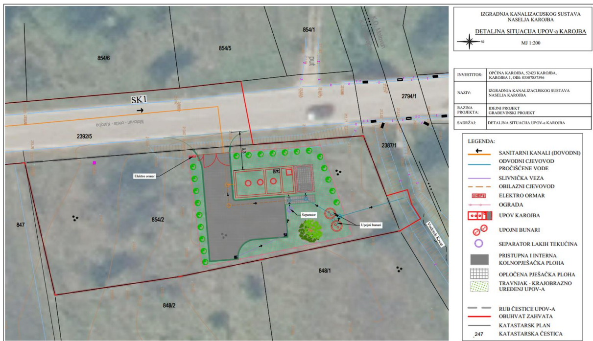
Slika 11. Detaljna situacija UPOV-a Karojba (Izvor: Idejni projekt, PRONGRAD BIRO d.o.o., Zagreb)
