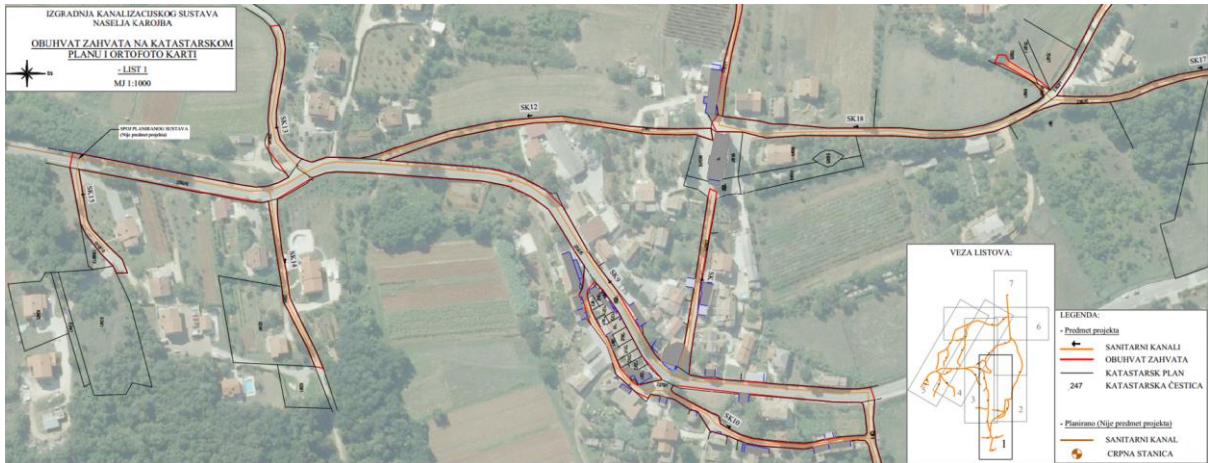
Slika 3. Izgradnja kanalizacijskog sustava naselja Karojba - raspored cjevovoda LIST 1
