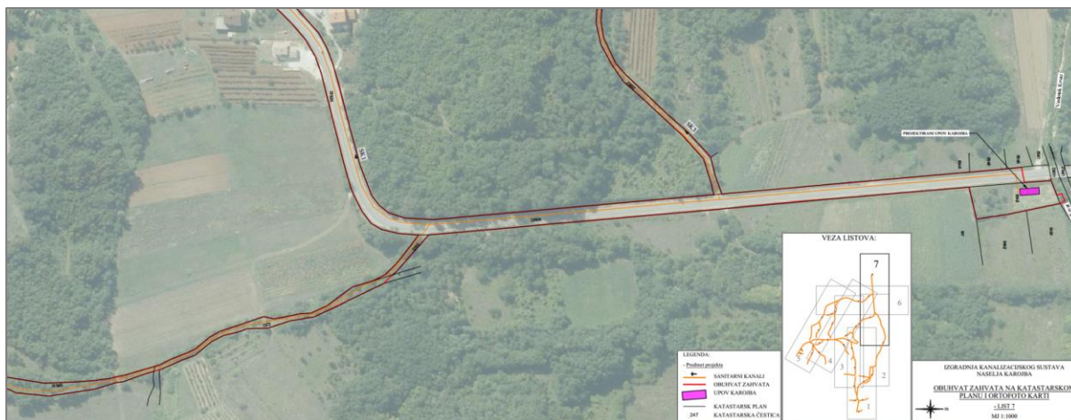
Slika 9. Izgradnja kanalizacijskog sustava naselja Karojba - raspored cjevovoda LIST 7
