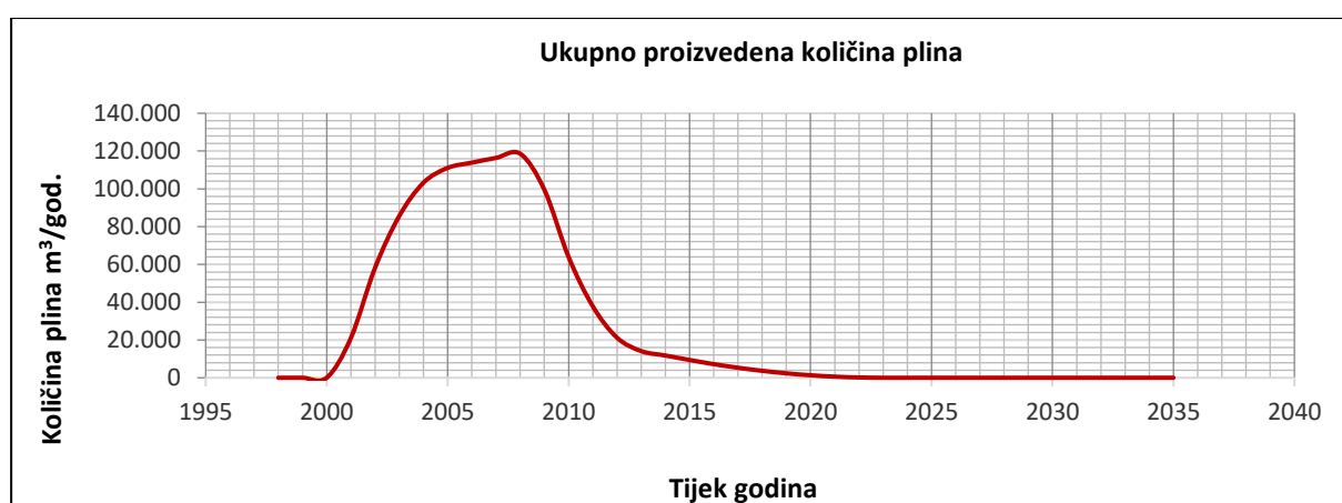
Grafikon 1 Ukupno proizvedena količina plina na odlagalištu do prekrivanja završnim brtvenim sustavom
