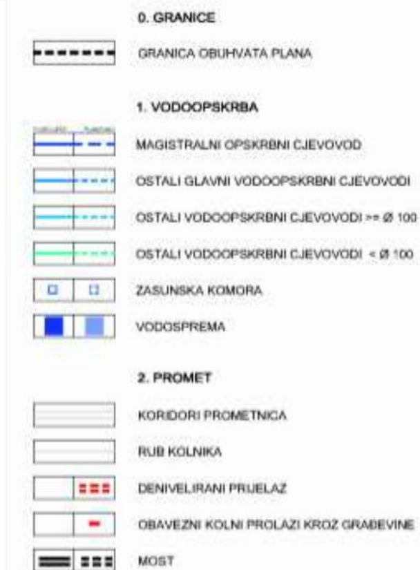
Slika 10. Izvod iz kartografskog prikaza 2E. Prometna, ulična i komunalna infrastrukturna mreža – vodoopskrba (izvor: UPU Slatina).
