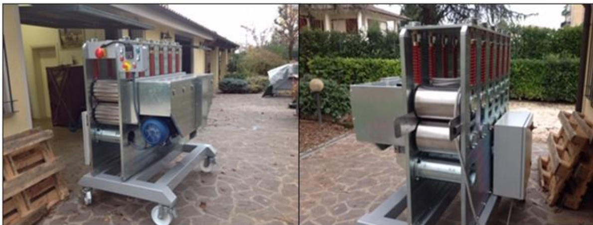
Slika 7. Stroj za prešanje bakalara
