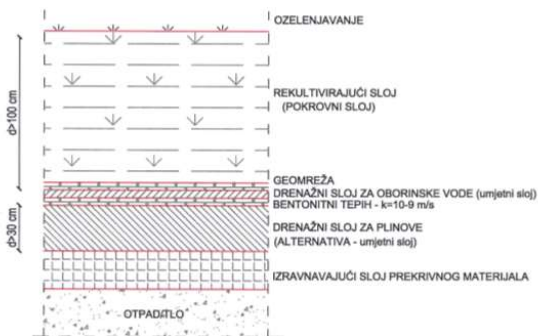
Slika 2.2.1/1 - Detalj završnog pokrovnog sustava
