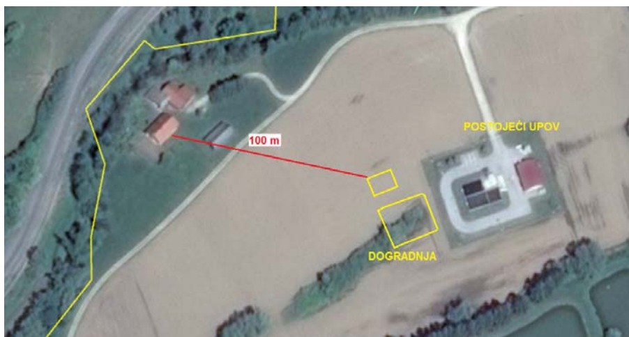
Slika 4.1 Udaljenost UPOV od naseljenih objekata
