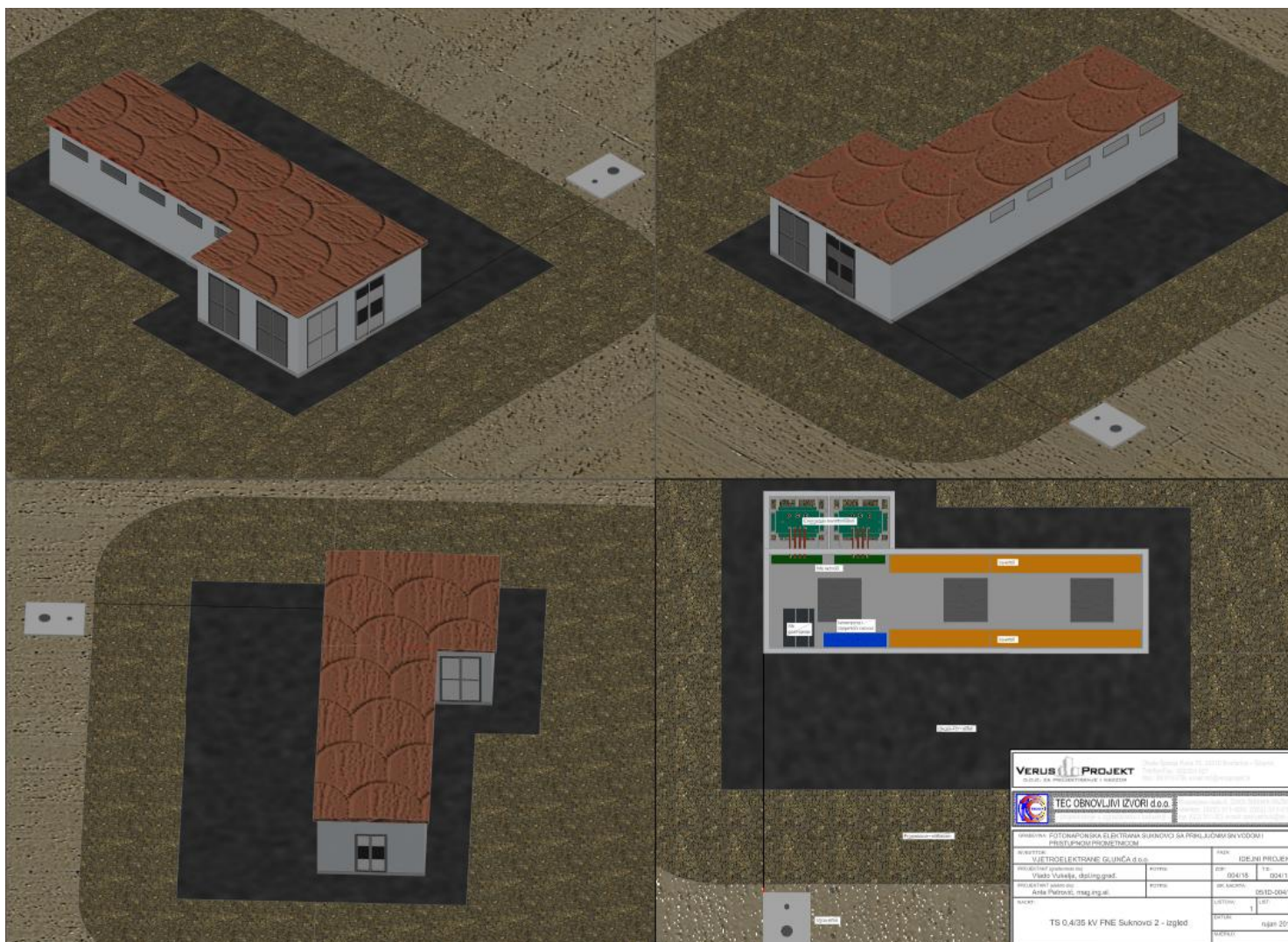
Slika 11. Idejno rješenje TS 0.4/35 kV FNE SUKNOVCI 2
