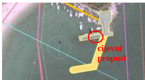
Slika 12. Predložena pozicija za izvedbu cijevnog propusta s ciljem povećanja intenziteta izmijene mora
