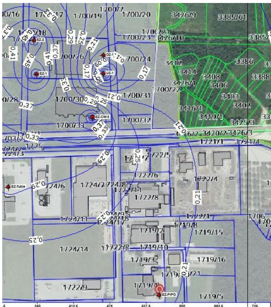
Slika 2. Utjecaj na sniženje razine podzemne vode zbog crpljenja eksploatacijskih zdenaca EZ-1 i EZ-2, crnom količinom u režimu rada te uvjet neprekidnog crpljenja u trajanju od 1 godine.
