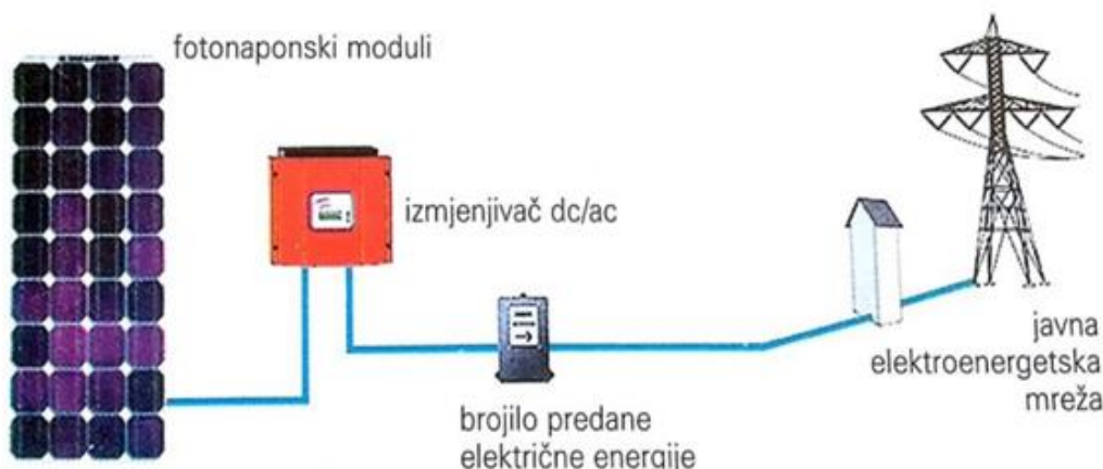
Slika 5. Fotonaponski sustav izravno priključen na energetska mrežu; Izvor: Ljubomir Majdandžić: Fotonaponski sustavi [Priručnik]
