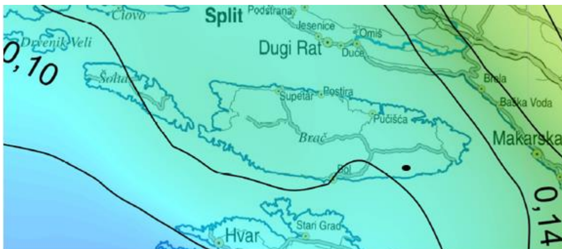
Slika 16. Približan položaj lokacije zahvata (crno) sukladno Karti potresnih područja za povratno razdoblje 95 godina, Izvor: http://seizkarta.gfz.hr , srpanj, 2020.
