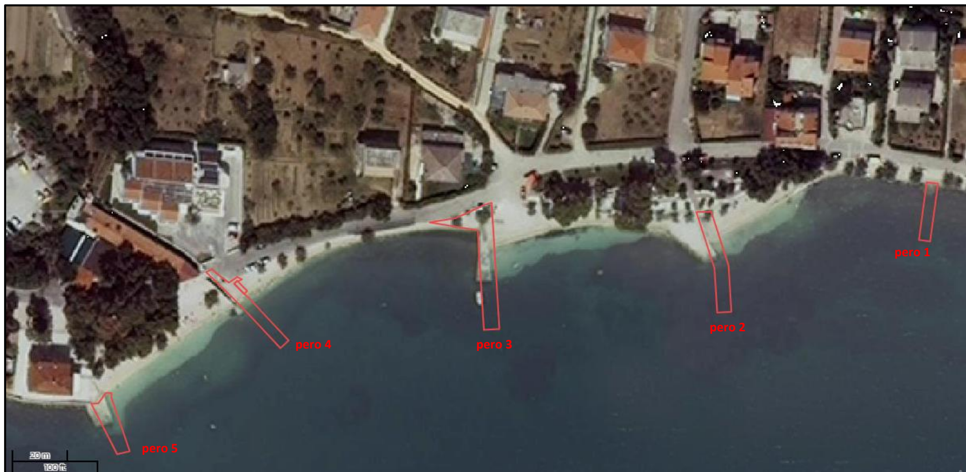
Slika 2.2-2. Situacijski prikaz zahvata s ucrtanim granicama planiranih pera (izvor: Bertolino inženjering d.o.o., 2019.)
