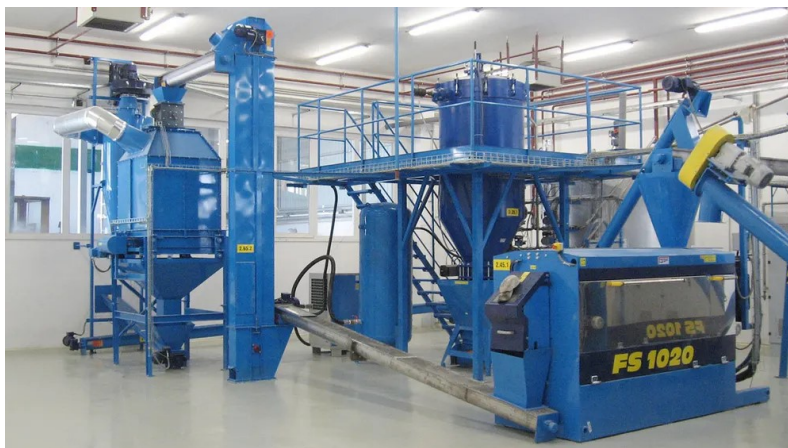
Slika 5. Postrojenje za proizvodnju hladno prešanog ulja (Izvor: https://www.farmet.es/hu/cp1-one-level-cold-pressing-24 )
