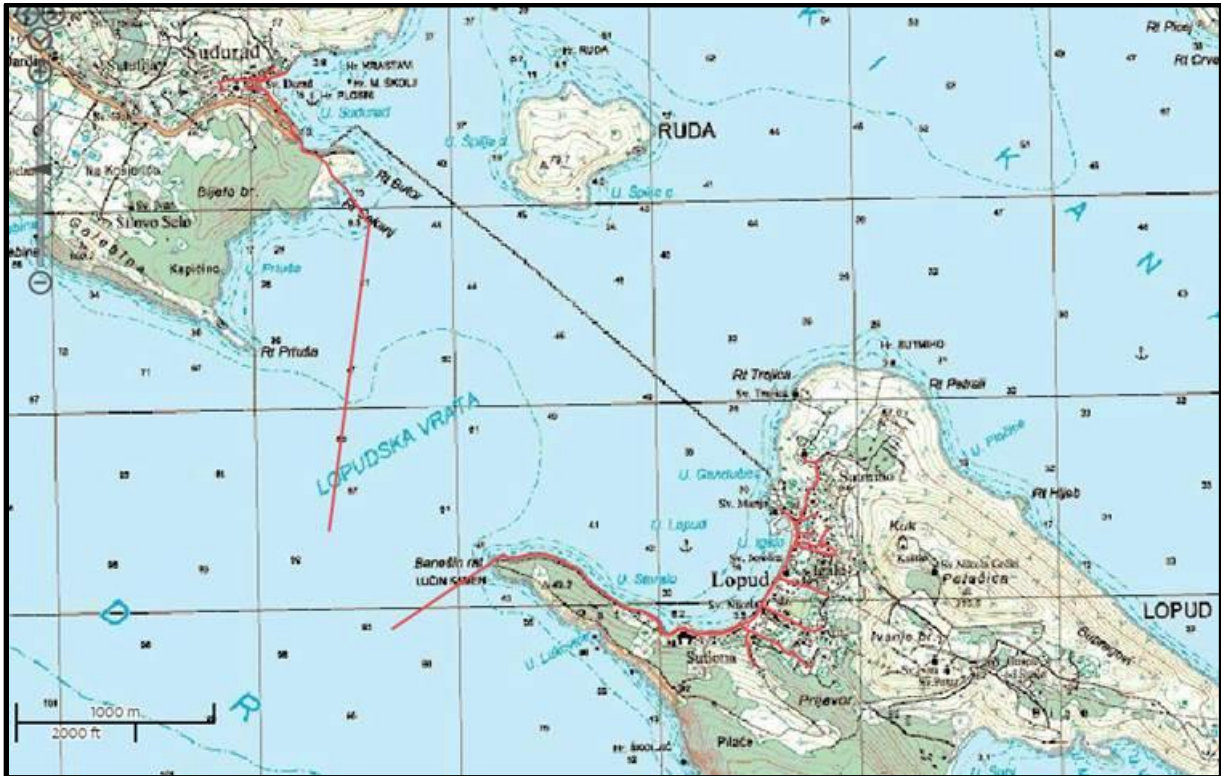
Slika 4.1-1. Situacijski prikaz sustava odvodnje i pročišćavanja otpadnih voda naselja Lopud i Suđurađ (na otoku Šipanu)
