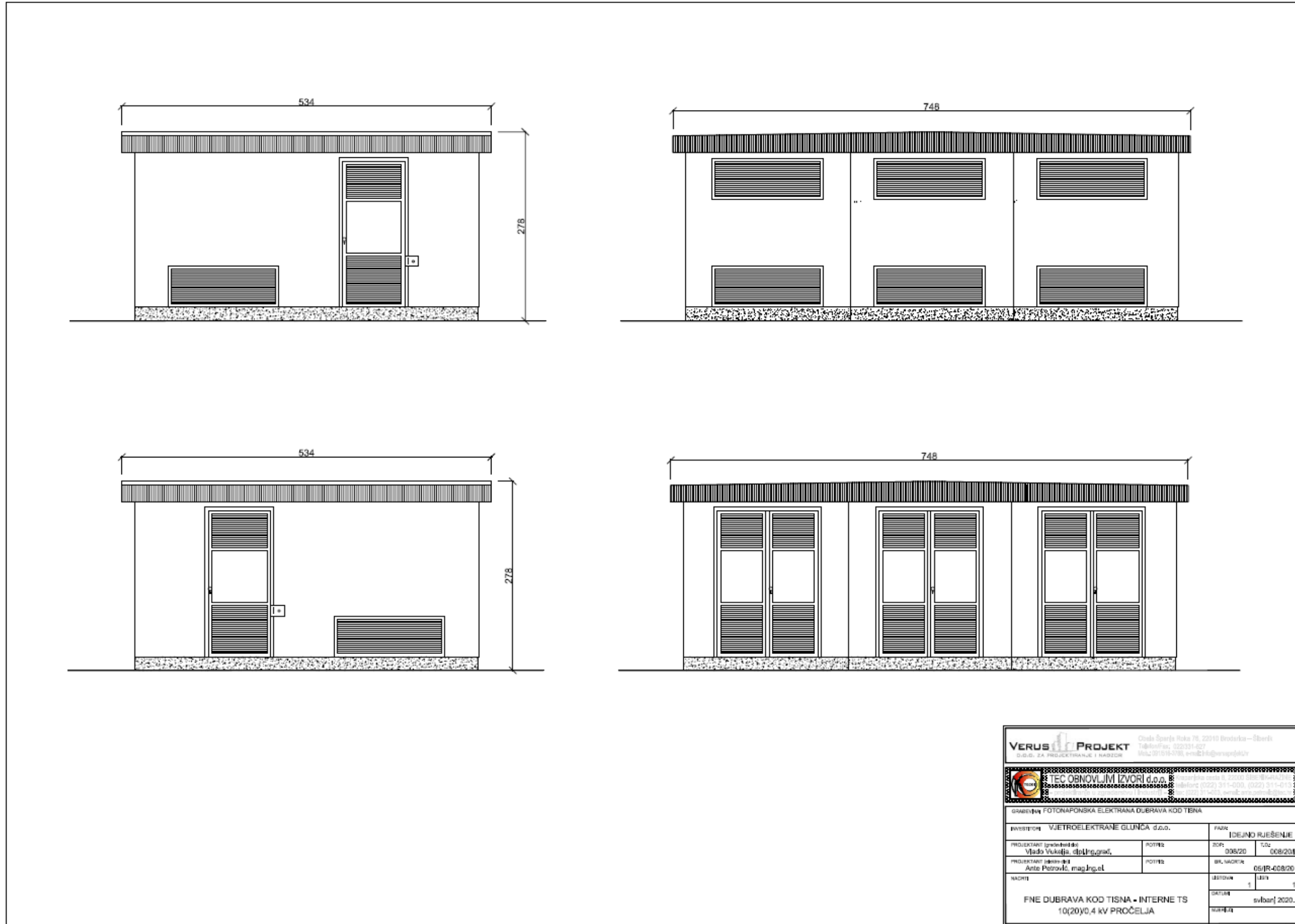
Slika 9. Pročelja internih TS 10(20)/0,4 kV; Izvor: IDEJNO RJEŠENJE -FOTONAPONSKA ELEKTRANA DUBRAVA KOD TISNA, TD: 008/20/ir, svibanj 2020., izrađivači: VERUS PROJEKT d.o.o. i TEC OBNOVLJIVI IZVORI d.o.o.
