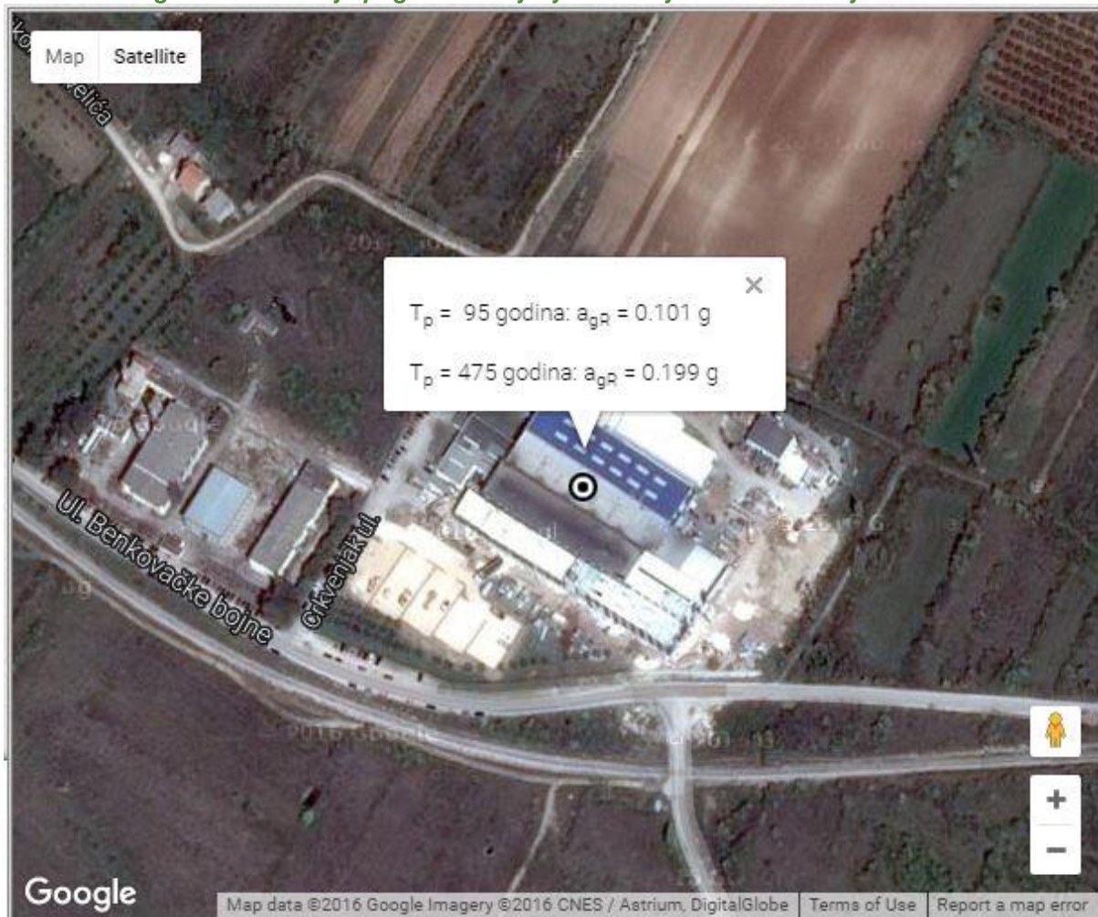
Slika 12 : Horizontalna vršna ubrzanja tla tipa A ( a_{gR} ) za povratna razdoblja od T_p = 95 i 475 godina za lokaciju pogona za taljenje aluminija LTH Metalni lijev d.o.o.
