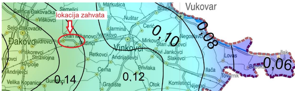
Slika 2.3.3-2. Izvod iz Karte potresnih područja za povratno razdoblje od 475 god (Izvor: http://seizkarta.gfz.hr/karta.php )
