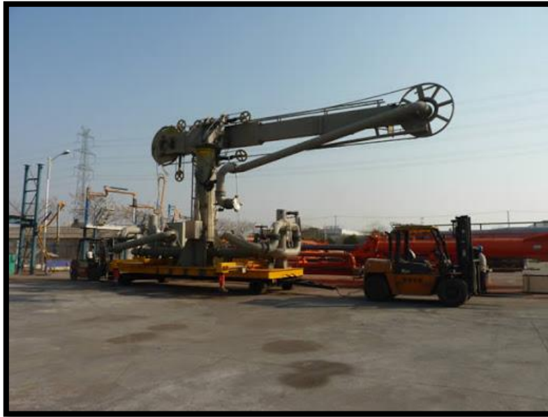
Slika 5. Primjer mobilne jedinice za pražnjenje/punjenje brodova ( Mobile marine loading arm )
