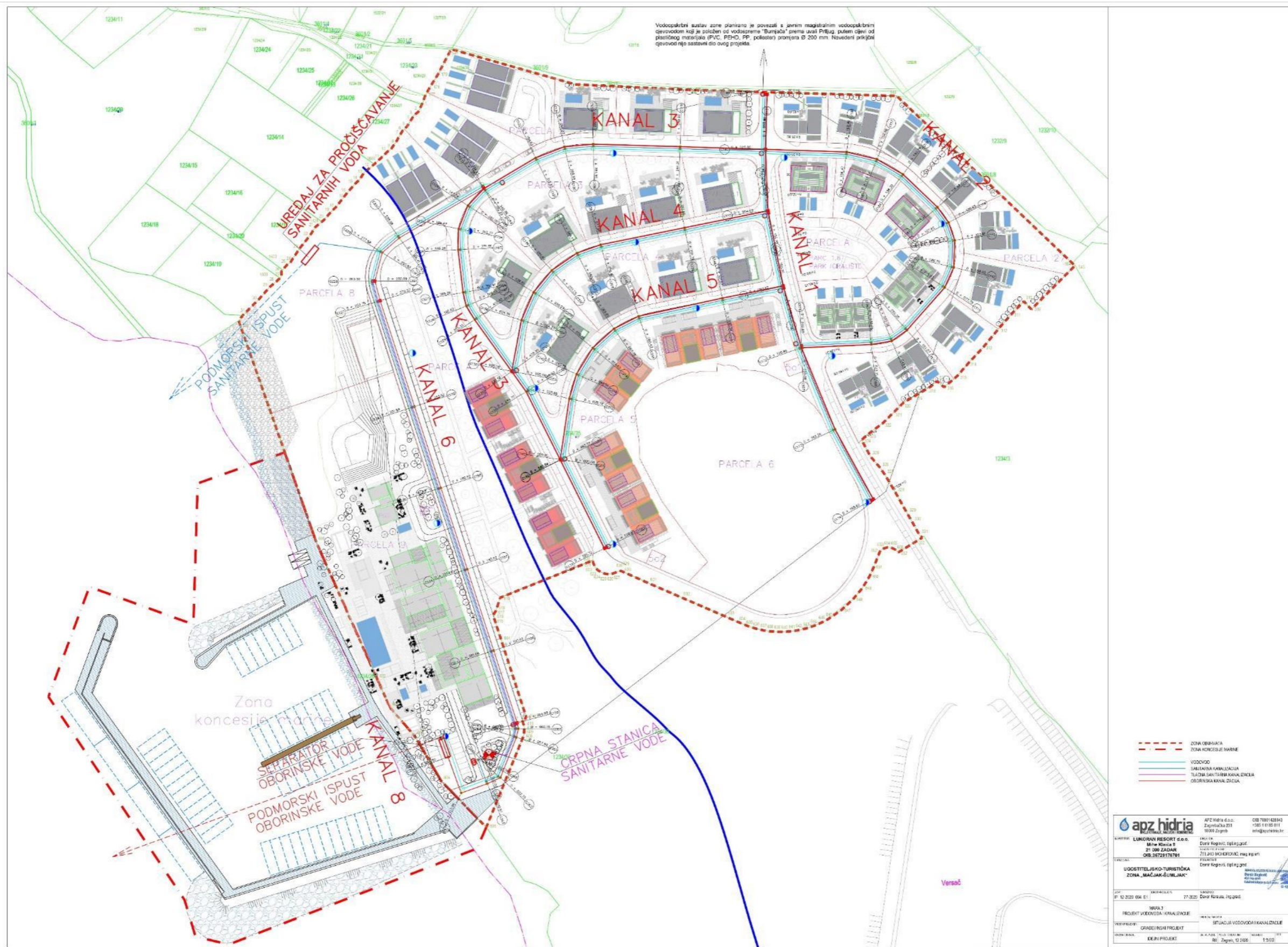
Sl. 2-3 Situacija vodovoda i kanalizacije (podmorski ispusti označavaju smjer trase istih, dok je krajnja točka ispusta navedena u tekstu pogl 2.1.2.5.2.)
