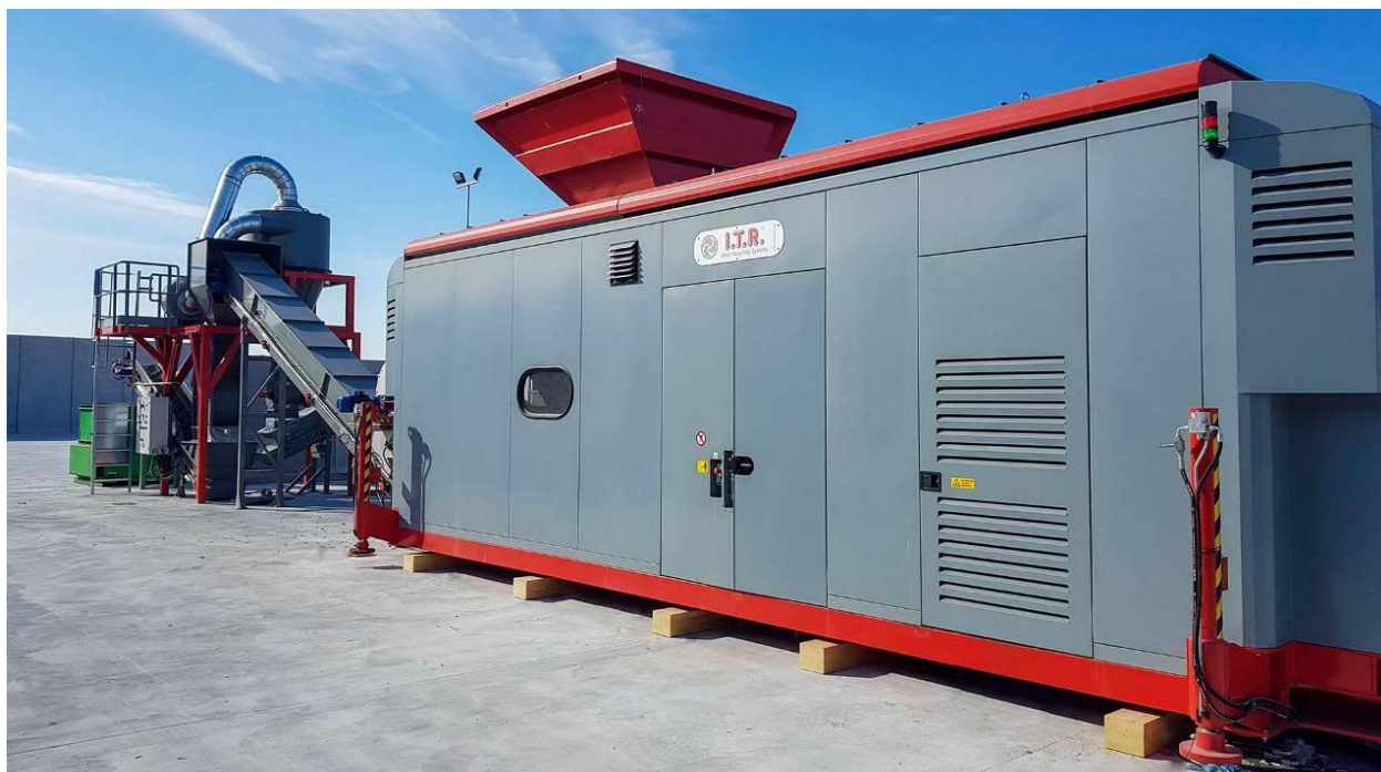
Slika 1./2. Uređaj za usitnjavanje i separaciju metalne frakcije [2]
