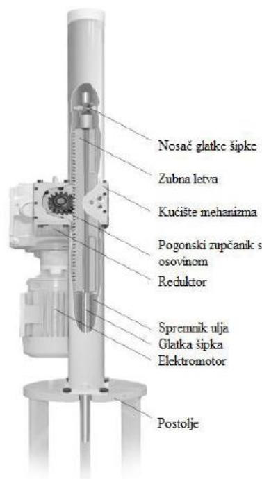
Slika 2.5-1. Prikaz glavnih dijelova dubinske sisaljke s linearnim sustavom podizanja fluida
