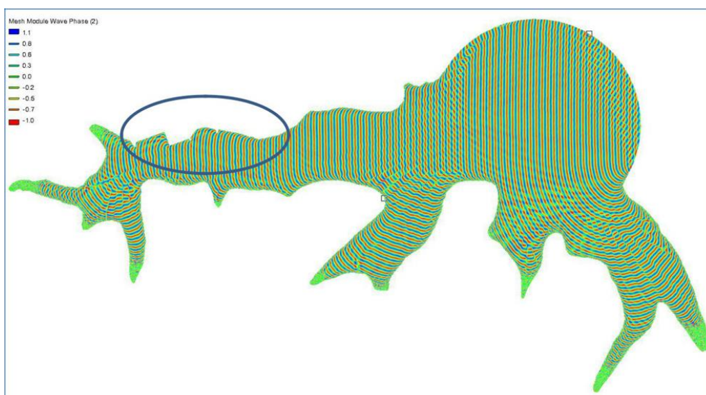
Slika 4 – Valne faze za simulaciju 2; značajni val povratnog perioda 100 godina iz incidentnog smjera E-180° ( H_s=1,76 m; T_p=3,68 s)
