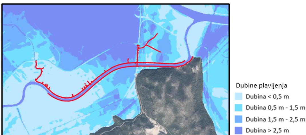
Slika 3.1.4-5. Karta opasnosti od poplava za malu vjerojatnost pojavljivanja s dubinama plavljenja za područje zahvata (izvor: Hrvatske vode, 2021.)
