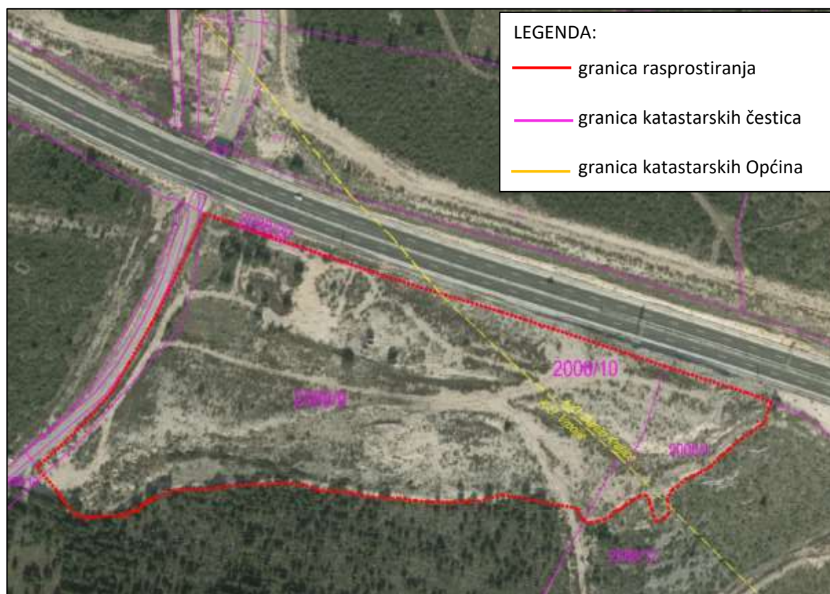
Slika 2.2.1.-1. Granica rasprostiranja iskopnog materijala prema geodetskoj snimci terena
