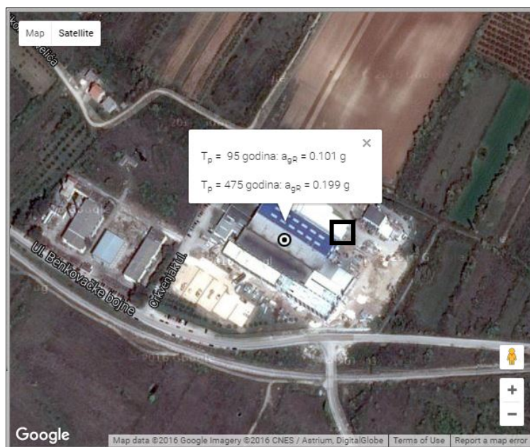
Slika 23. Horizontalna vršna ubrzanja tla tipa A ( a_{gR} ) za povratna razdoblja od T_p = 95 i 475 godina za lokaciju pogona za taljenje aluminija LTH Metalni lijev d.o.o. ( http://seizkarta.gfz.hr/karta.php )
