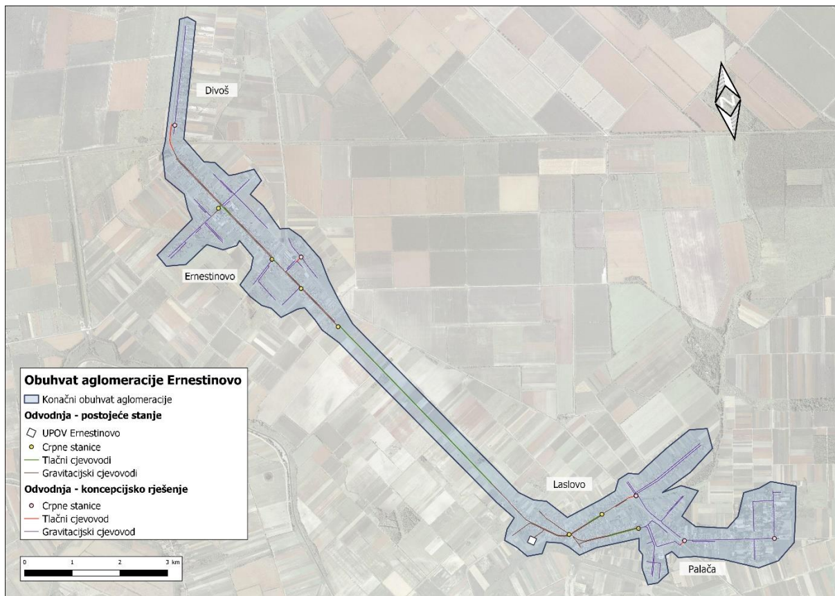
Slika 2.5 Izgradnja sustava odvodnje naselja Ernestinovo, Laslovo, Divoš i Palača
