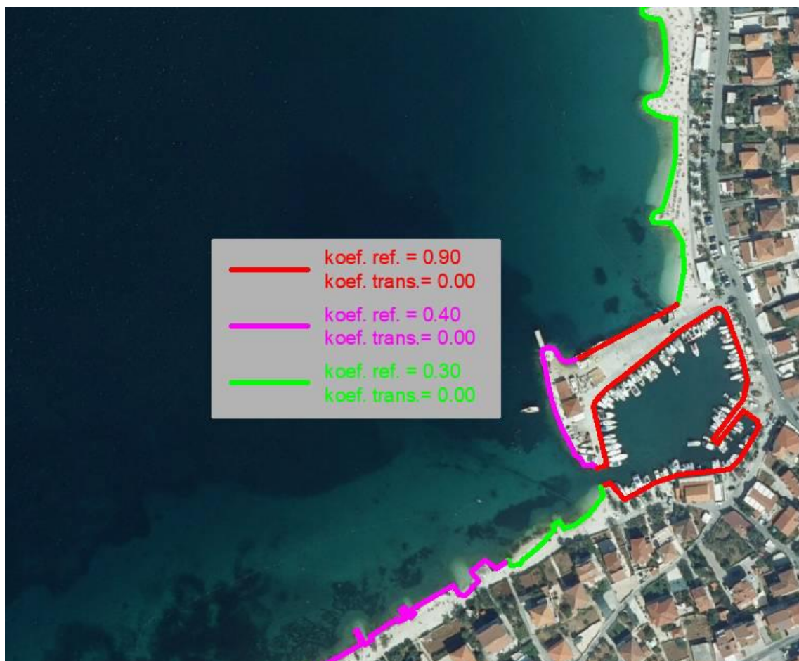
Slika 2.11 Koeficijenti refleksije detaljnih numeričkih simulacija
