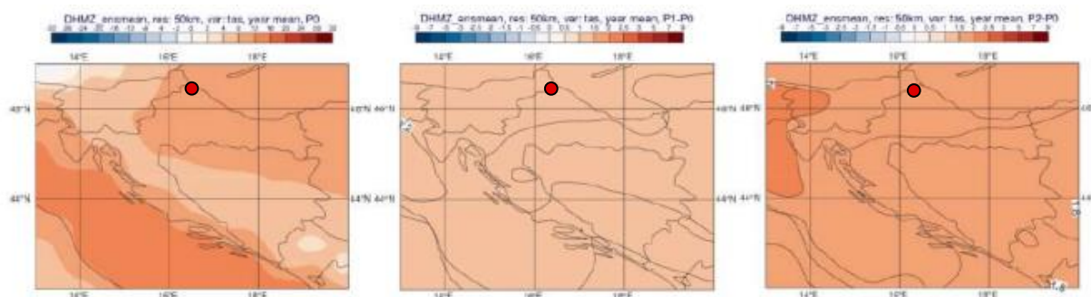
Slika 35. Srednja godišnja temperatura zraka (°C) u srednjaku ansambla iz četiri integracije RegCM modelom. Lijevo: referentno razdoblje 1971.-2000.; sredina: promjena u razdoblju 2011.-2040.; desno: promjena u razdoblju 2041.-2070.
