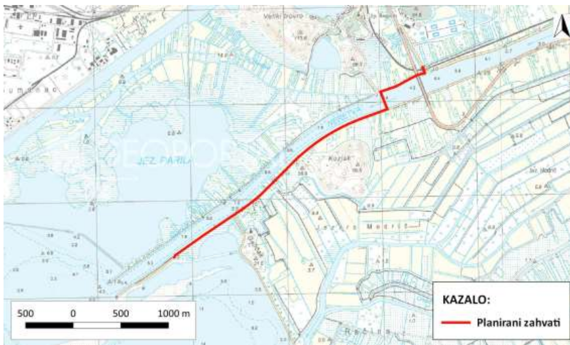
Grafički prikaz B-2: Situacijski prikaz Vodoopskrbnog cjevovoda za opskrbu lijeve obale ušća Neretve Izvor: Glavni projekt „Vodoopskrbni cjevovod za opskrbu lijeve strane ušća rijeke Neretve“ (GEOPROMING d.o.o., Metković, travanj 2020.g.)
