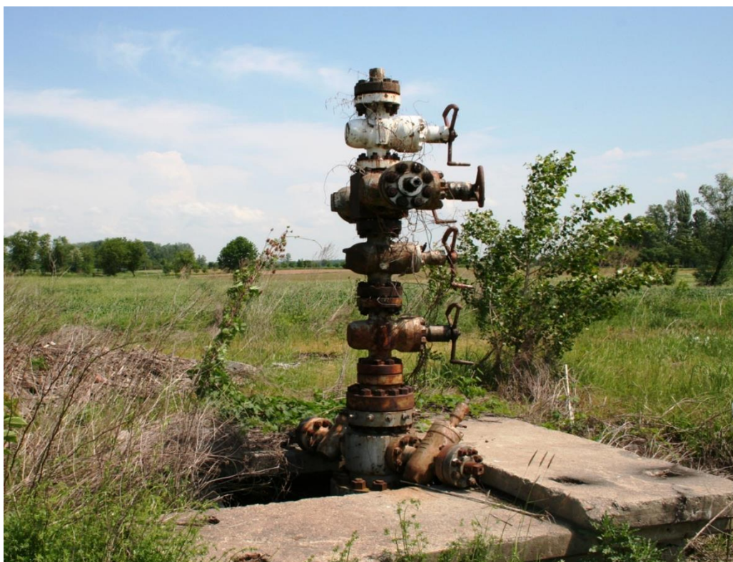
Grafički prikaz 3-2: Mikro lokacija bušotine BaG-1 i bušotinska glava BaG-1
