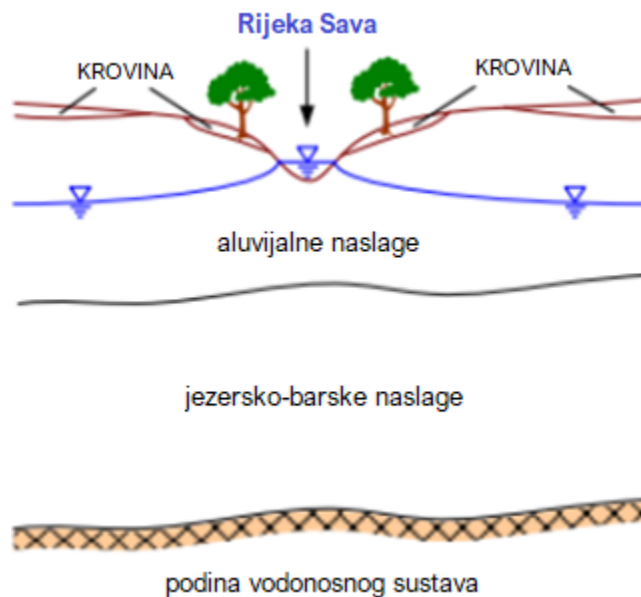
Slika 2.21. Shematski profil zagrebačkog vodonosnog sustava (preuzeto iz Posavec)
