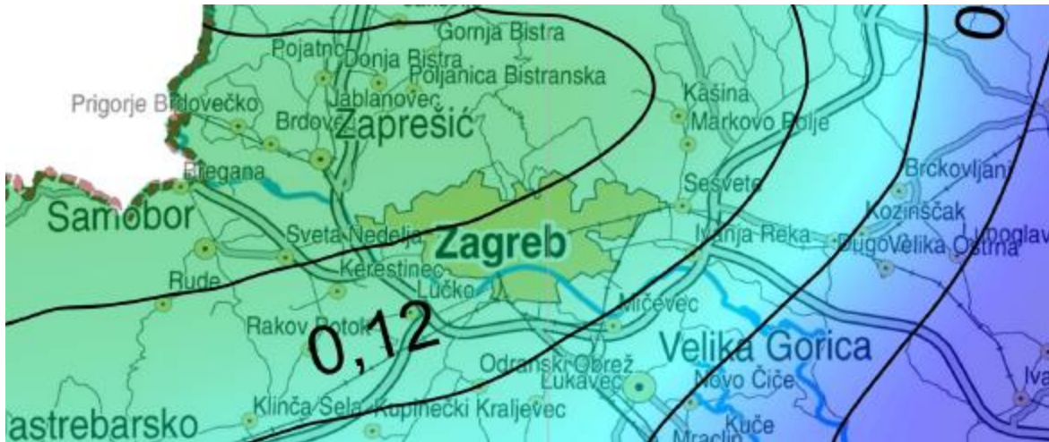
Slika 2.19. Karta poredbenog vršnog ubrzanja tla „A“ okolnog područja za povratno razdoblje od 95 godine. Izvor: Karta potresnih područja Republike Hrvatske Geofizički odsjek PMF, Zagreb
