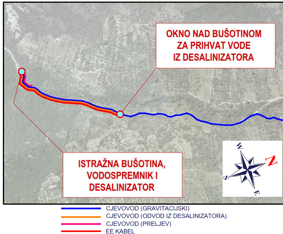
Slika 2.2-2. Odnos položaja vodocrpilišta (istražna bušotina), desalinizatora i vodospremnika te ispusta koncentrata iz desalinizatora ( preuzeto iz: Hidroprojekt-ing d.o.o., 2021. )
