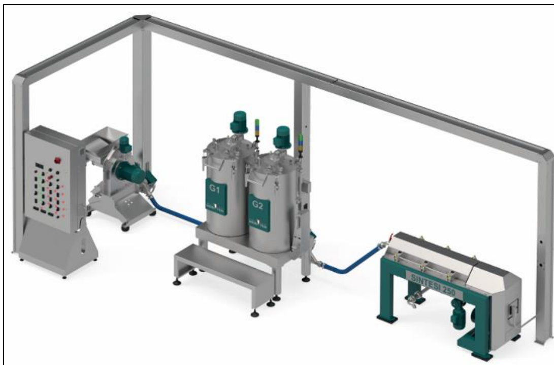
Slika 13.: Planirana oprema za proizvodnju maslinovog ulja - Sintesi model
