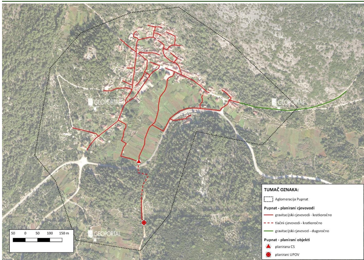
Grafički prikaz A-5: Prikaz planirani radovi na sustavu odvodnje i pročišćavanja u kratkoročnom i dugoročnom razdoblju na ortofoto podlozi
