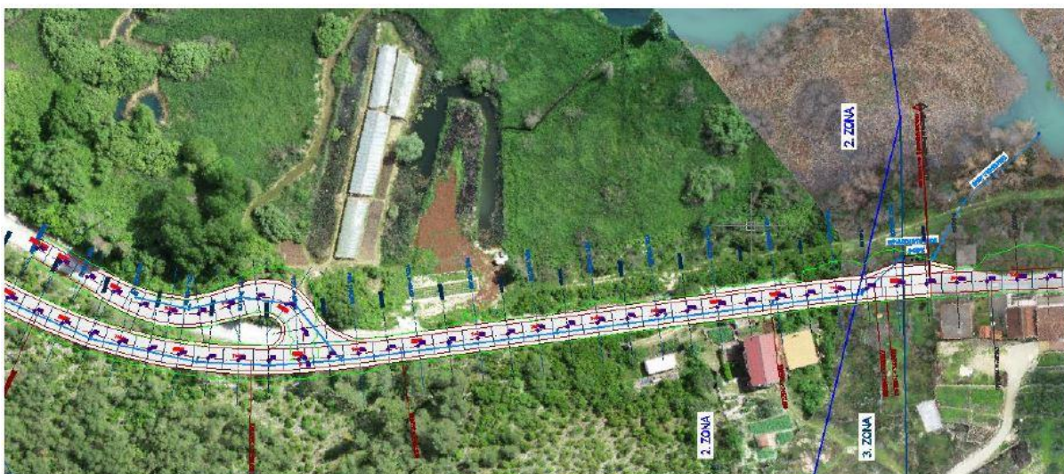
Slika 1.1 - 3 Fragment prometnog rješenja križanja osi 1 i osi 2 (ŽC6218) (Izvor: Idejno rješenje)
