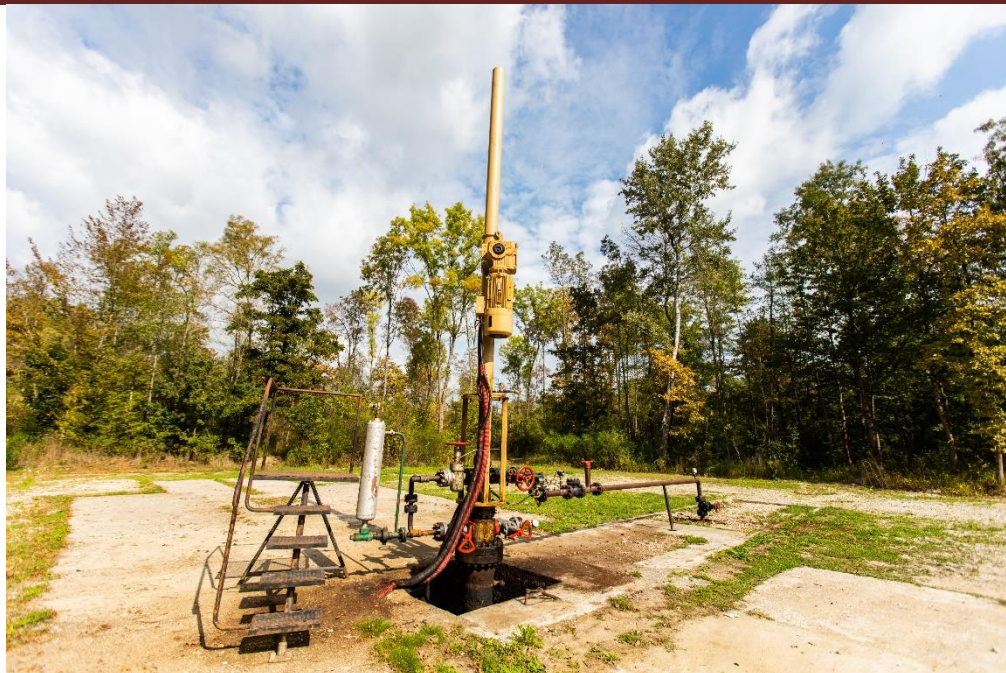
Slika 1.4.14. Naftna bušotina Žu-115 opremljena s linearnim sustavom podizanja fluida dubinskom sisaljkom
