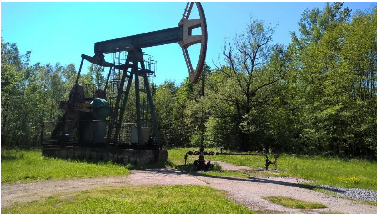
Slika 1.4.13. Naftna bušotina s dubinskom sisaljkom Žu-177
