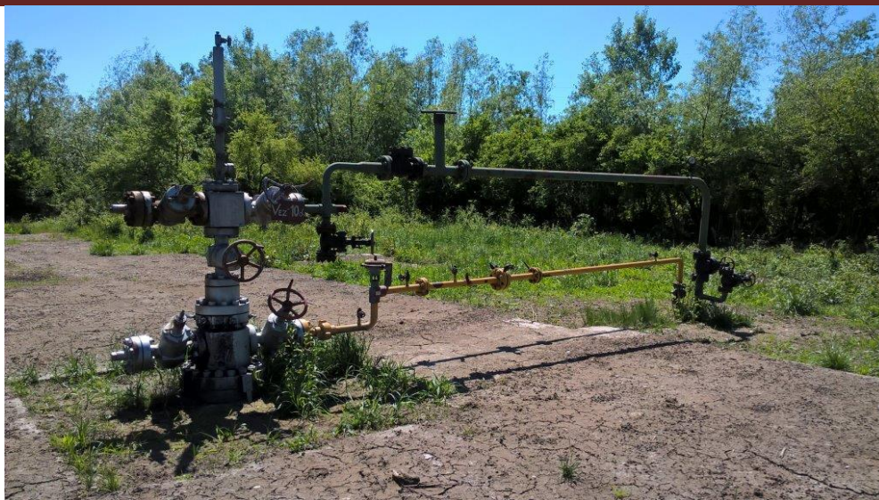
Slika 1.4.16. Naftna bušotina Vz-10α opremljena sustavom s plinskim podizanjem
