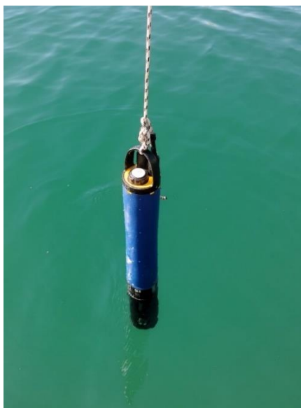
Slika 3_42 Multiparametna sonda YSI EXO 2
