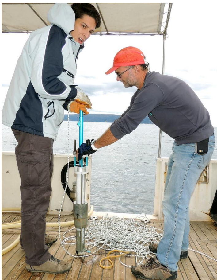
Slika 3_40 Uzorkovanje sedimenta gravitacijskim korerom Uwitec.
