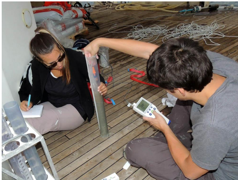
Slika 3_39 Određivanje redoks potencijala u prvih 10 cm sedimenta
