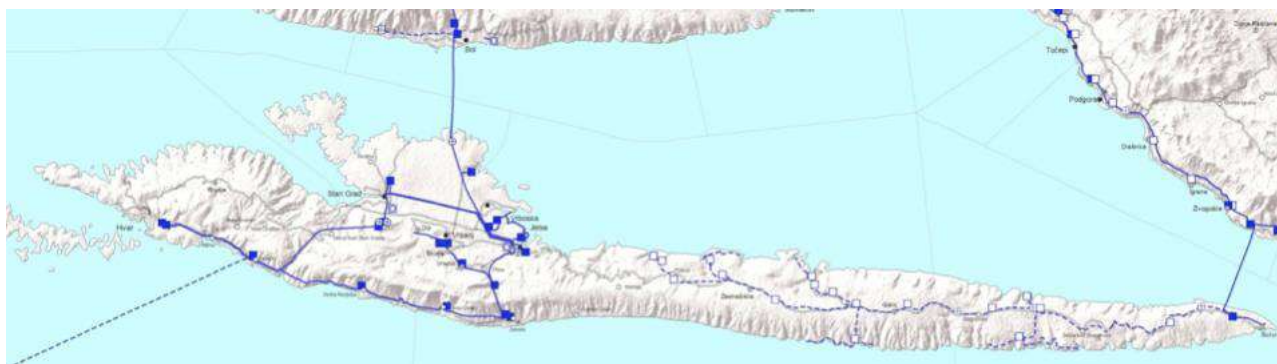
Slika 1.8.-1. Vodoopskrbni sustav otoka Hvara
