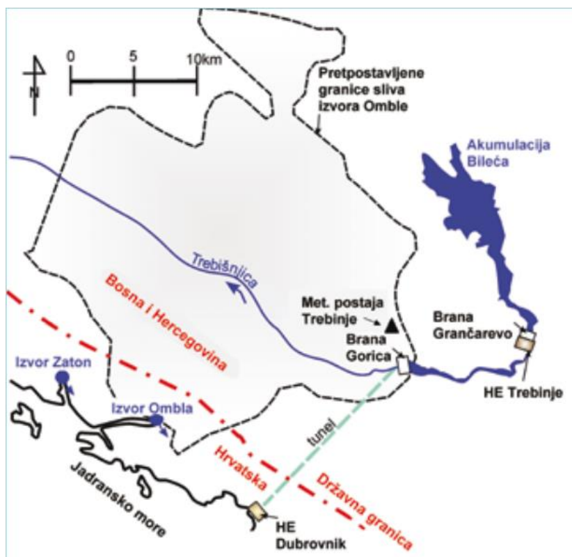
Slika 8: Situacija analiziranog područja s ucrtanom pretpostavljenom granicom sliva izvora Omble, položajem izvora Zaton, rijeke Trebišnjice, meteorološke postaje Trebinje, granice između Bosne i Hercegovine i Hrvatske te položaja izvedenih brana, akumulacija i hidroelektrana (HE)
