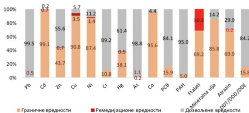
Slika 1.32. Procenat prekoračenja na dubini od 30-60 cm na centralnim tačkama deponija (AP Vojvodina)
